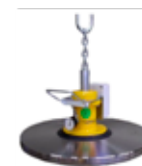
Mechanische vacuÛmzuiger: tijdens het hijsen wordt een zuigerstang omhoog getrokken welke een vacuÛm
